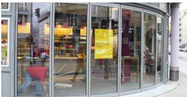
Sonderlösungen für Shop-Fassaden. Bildbeispiel: Faltschiebeanlage System Dorma HSW-Iso-gerahmt in polygonaler Ausführung.
